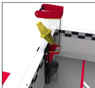
图 SG11-2: 当导入桶抬起后, 得分物可以从导入桶顶部背部导入
